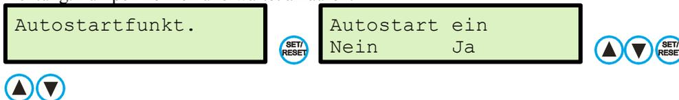
Wenn die **Sicherstartfunktion** gewählt ist, wird nur! nach dem Einschalten der Netzspannung oder nach einem Spannungsausfall die Pumpe(n) in Sicherheitsmodus automatisch gestartet.
