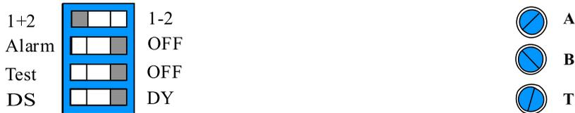
Mit dem Drehschalter **A**, Text „EIN“, stellen Sie den Einschaltdruck zwischen 0-100% ein. Sie sollten den Einschaltdruck möglichst niedrig einstellen.
