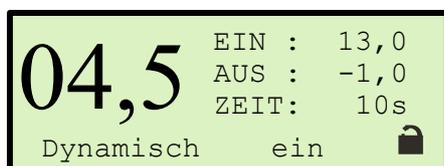
Im **Automatikbetrieb** regelt der Pumpen - Regler dem Druck automatisch nach den eingestellten Werten. Wichtig: **Kontrolle!**
